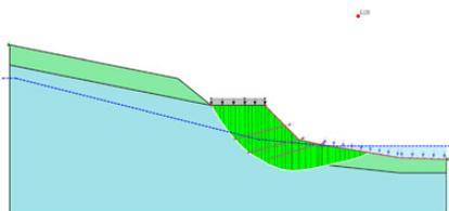
Superfície de deslizamento abaixo da rodovia simulando uma rodovia resistente
