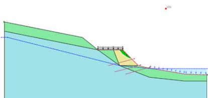
Superfície de deslizamento abaixo da rodovia simulando uma rodovia frágil
